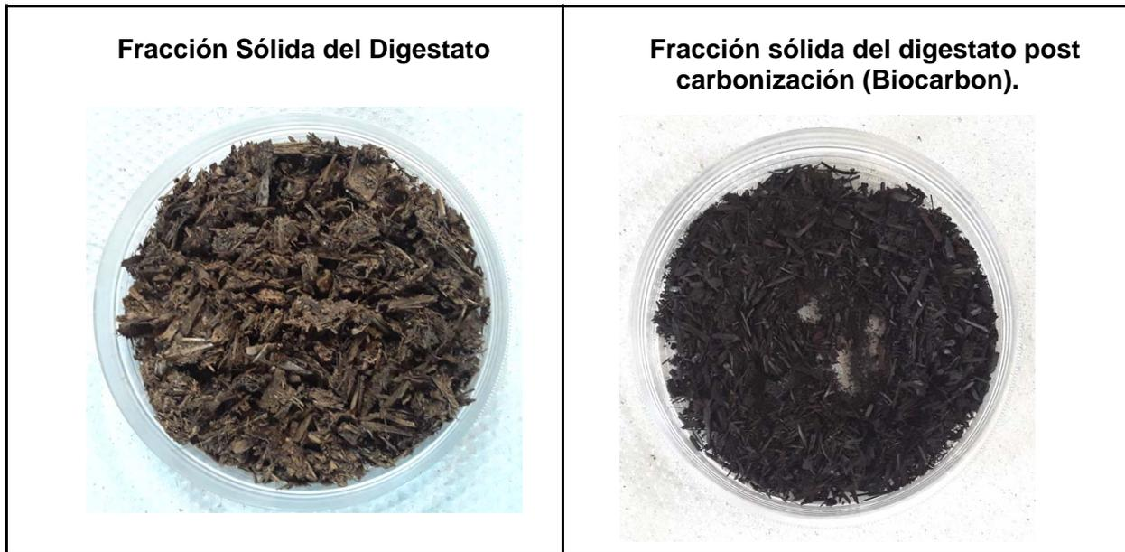
**Figura 5.** Digestatos y Biocarbones. Fuente: Elaboración propia.
